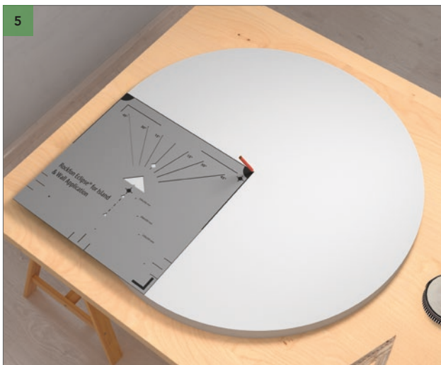
Placera mallen på väggabsorbentens baksida så att översta vänstra och nedersta högra hörnen är i nivå med absorberens kant. Markera centrumlinjerna genom att rita längs mallens hörn. Se fig. 5 - Resultat.
