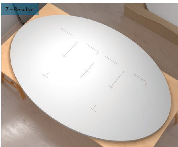
Mät ut och gör ett kryss på c/c 300 mm på var sida om centrumlinjen.
