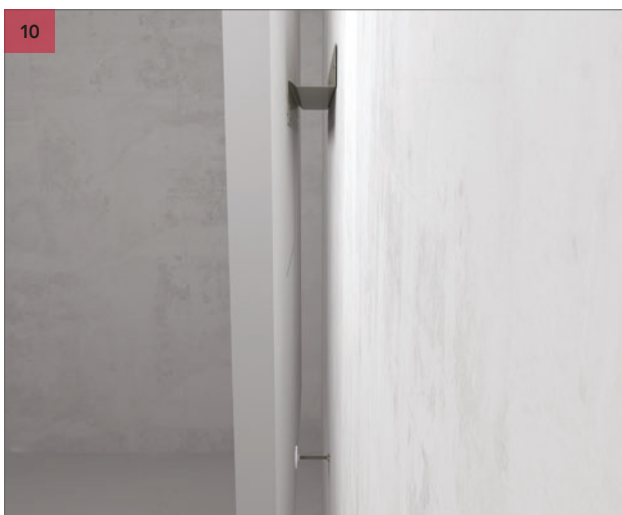
Häng upp väggabsorbenten på väggfästet eller z-profilen och justera distanshållaren så att Rockfon Eclipse väggabsorbent hänger rakt. Se fig. 10 - Detalj.
