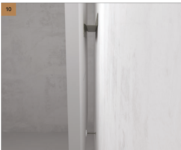
Häng upp väggabsorbenterna på väggfästet eller z-profilen och justera distanshållaren så att Rockfon Eclipse väggabsorbent hänger rakt. Se fig. 10 - Detalj.
